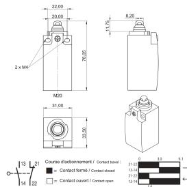
Interruptor para conectar a los contactos normalmente cerrados del módulo de control de la puerta para la apertura manual de la puerta. Esto se utiliza principalmente para luces y soluciones de refrigeración que deben estar vinculadas a la apertura o cierre de la puerta.
