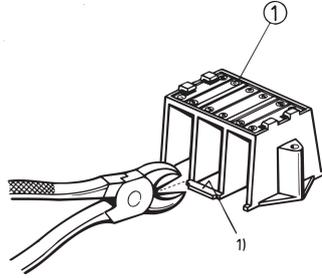
Soporte de montaje para Busbar 1, 2-Pole.
