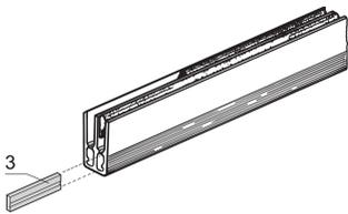
Bloques aislantes para barras colectoras para proteger los terminales de cortocircuitos accidentales y daños. Los bloques proporcionan un soporte rígido para separar físicamente las barras de bastidor de todas las fuentes de energía eléctrica y están diseñados para un fácil montaje de la barra de bastidor.
