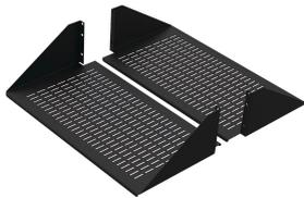
El rack con respiradero de acero de doble cara se monta en las bridas delantera y trasera de un rack de marco abierto. Consta de dos estantes montados a cada lado del rack de marco abierto para formar un estante de doble cara. Permite más flujo de aire que las versiones de acero y aluminio. La clasificación de carga del estante es de 300 lb (136.1 kg)
