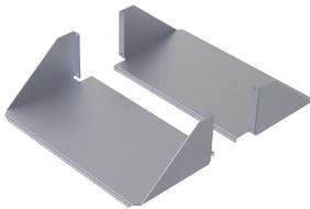
El estante de aluminio sólido de doble cara se monta en un rack de marco abierto de 19 pulg. Consta de dos estantes montados a cada lado del rack de marco abierto para formar un estante de doble cara. Es una solución más ligera que la versión de acero. Este sistema utiliza espacio de rack 4U y la clasificación de carga máxima es de 100 lb (45.4 kg) por lado, 200 lb (90.7 kg) en total.
