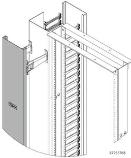
La cubierta trasera CableTek es un accesorio para todos los administradores verticales de cables CableTek con poste y compuertas. Proporciona un aspecto estético y acabado y protege el cable en un organizador de cables CableTek. Para el manejo de doble cara, las cubiertas se adjuntan al poste y las puertas incluidos. Para el manejo de una sola cara, el kit de poste y puerta debe pedirse por separado.
