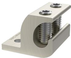
Las terminales mecánicas de tendido son de doble clasificación, conectores con certificación UL486B que unen de forma segura el extremo del cable a un rack. Están hechos de aluminio 6061-T6 electrochapado. Requieren una llave hexagonal de 3/16 pulg. (no incluida).
