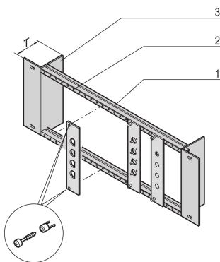
El soporte del módulo es necesario para el montaje de paneles frontales de ancho parcial con recortes SUB-D, ST tipo 3 o FDDI, con o sin riel de alivio de tensión.
