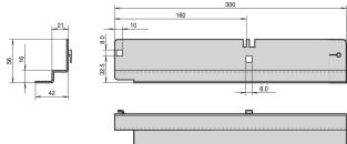
Carril deslizante Labrack con capacidad de carga de 40 kg para el montaje en los verticales desnudos del gabinete o soportes deslizantes de 19". El carril deslizante soporta estante de pesado 19" chasis.
