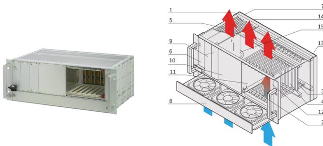
Sistema CompactPCI de 4 U con jaula de tarjeta vertical para ocho placas 3U, ocho placas RTM y una fuente de alimentación enchufable de 3U.
