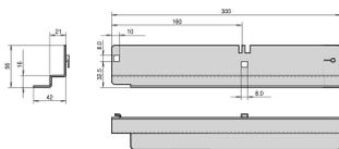
Carril deslizando Labrack con capacidad de carga de 40 kg para el montaje en los verticales desnudos del gabinete o soportes deslizando de 19". El carril deslizando soporta estante de pesado 19" chasis.
