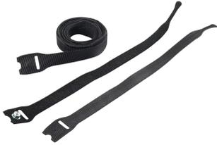
El rack para cables VELCRO® sujeta firmemente el cable a una gestión de cableado y se desabrocha fácilmente para el mantenimiento del cable. El VELCRO® tiene 0.5 pulgadas (12.7 mm) de ancho. Está disponible en longitudes de 8 y 12 pulgadas (203 y 305 mm) en estilos de sujetador de tornillo y de envoltura. El tornillo autorroscante M5 se utiliza en marcos ProLine. Tenga en cuenta que VELCRO es una marca comercial de Velcro Industries BV
