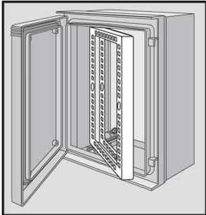
El marco abatible proporciona capacidades de montaje para racks de 19 pulg. con patrón de orificios de montaje estilo U (Tipo RA). El cerrojo de un cuarto de vuelta tiene un rango de 100°. Disposición de montaje ajustable. El marco abatible mantiene la clasificación de gabinete si se instala correctamente en un gabinete nVent HOFFMAN. La posición de montaje frontal es de aproximadamente 140 mm (5.5 pulg.) en los gabinetes de 400 mm. Incluye hardware de montaje y manual de instrucciones.
