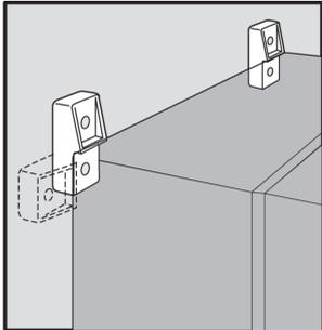
El kit de soporte de montaje Ultrx puede instalarse en campo. Se incluye hardware de montaje de acero inoxidable 316. Cuatro soportes de montaje por kit.
