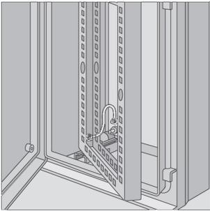
El dispositivo de conexión a tierra proporciona un medio para conectar un conductor de conexión a tierra a un panel o marco abatibles Ultrx. Se incluyen todas las instrucciones de instalación y el hardware de montaje.
