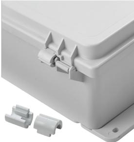
Los retenedores de bisagra PolyPro pueden instalarse en campo sin modificar las bisagras PolyPro para aplicaciones en las que no se desea una fácil extracción de la cubierta. Se recomiendan dos retenedores por gabinete. El kit incluye diez retenedores de bisagra.
