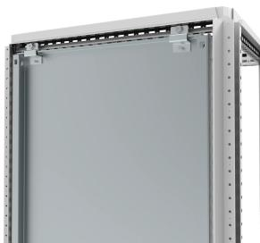
Este kit de fijación para placa de montaje permite instalar una placa de montaje por la parte trasera. Puede colocarse a ras del bastidor del armario o detrás de este, con lo que se añaden 20 mm adicionales de profundidad útil del armario.
