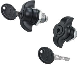
La perilla mariposa de cuarto de vuelta del sistema de cierre bloquea una variedad de gabinetes de montaje en pared. La perilla mariposa incluye una junta, tuerca de montaje y una llave con el código de llave 333. Esta perilla mariposa debe usarse con una leva existente para su instalación; tenga en cuenta que la leva no está incluida con la perilla mariposa. Se puede bloquear en posición abierta o cerrada. Este producto mantiene la clasificación del gabinete Tipo 4, 12.
