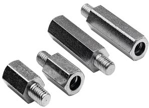
Los extensores de panel roscados están diseñados para elevar la superficie de montaje del panel. Los extensores se conectan a las almohadillas internas roscadas. Tamaño de rosca macho y hembra 10-32.
