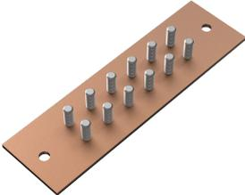
El buss de tierra es una barra de cobre que cuenta con puntos de conexión de cableado dentro del gabinete, lo que proporciona un punto de conexión a tierra central. Se coloca sobre los montantes provistos en el lado del gabinete. La separación entre los puntos de amarre es de 3/4 pulg. entre pares y 5/8 pulg. en cada par. Los pernos de tierra son de 1/4-20 x 0.75 pulg. en centros de 3/4 pulg.
