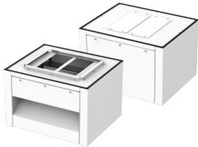
Las bases para respiradero están diseñadas para usarse con paquetes de impulsor nVent HOFFMAN e incluyen una malla de acero inoxidable para evitar la entrada de residuos. Las bases para respiradero cuentan con una disposición para instalar fácilmente un filtro de horno estándar. Si se usan bases para respiradero, se recomienda un filtro de horno de flujo de aire máximo. No se proporcionan filtros. Las bases sólidas están diseñadas para usarse con una solución de refrigeración de bucle cerrado.
