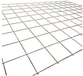
La malla prefabricada para conexión a tierra también es fácil de instalar, ya que no requiere excavaciones ni cavado de trincheras. Simplemente se desenrolla en el suelo, se interconecta soldando las secciones adyacentes de malla utilizando nVent ERICO Cadweld y después se suelda a la malla principal de conexión a tierra o a varillas de conexión a tierra. La malla puede cubrirse con una capa de tierra o de piedra triturada, dependiendo de la aplicación.
