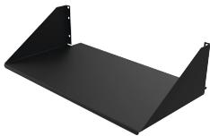
El estante de acero sólido de cara sencilla se monta en la brida delantera o trasera del rack de marco abierto, lo que da soporte a los equipos que no se montan en los ángulos del rack. Utiliza 3U de espacio en rack y tiene una clasificación de carga de 150 lb (68.0 kg).
