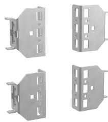
Los soportes reductores de marco se montan directamente en marcos ProLine de 700 mm u 800 mm de ancho o en un canal de montaje. Convierten marcos más anchos a 600 mm de ancho, permitiendo encajar ángulos de rack de hasta 19 pulgadas o 700 mm de ancho, así como ángulos de rack de 23 pulgadas. Pueden usarse para justificar a la izquierda o a la derecha el equipo montado en rack. Tenga en cuenta que se suministran en juegos de cuatro y se incluyen accesorios de montaje.
