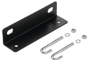
El soporte de ángulo para pared de la guía de cables proporciona soporte para la escalerilla desde una pared u otra superficie plana. Está hecho de acero pintado o chapado de 2 pulg. x 2 pulg., calibre 10. El kit incluye dos pernos en J, tuercas y tornillos.
