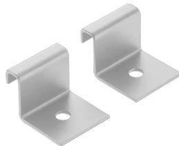
El soporte vertical de pared para guía de cables fija las secciones de escalerilla a una pared u otra superficie plana. Cuenta con un enganche en forma de U en los rieles de la escalerilla con una curva de 90 grados en el otro extremo para montarse sobre una superficie perpendicular. Requiere herraje de montaje en superficie (no incluido).
