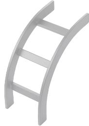
Las secciones curvadas de la escalerilla proporcionan un cambio vertical en la dirección. Están hechas de acero tubular de 1-1/2 pulgadas x 3/8 pulgadas (38 mm x 8 mm) con un acabado pintado o chapado. Los travesaños se sueldan en el interior (dobladuras interiores) o en el exterior (dobladuras exteriores) de la sección. Se conectan a la sección recta con kits de conexión de empalmes. También están diseñados para cables de fibra óptica de categoría 5e, 6, 6A.
