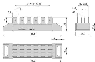
Barra de busbo con conexiones FASTON, con 24 contactos. Esto está diseñado para el suministro de voltaje de red a la 19".
