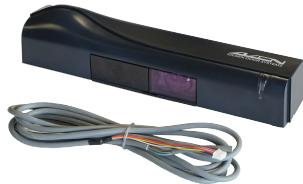
Detector de movimiento: Preparado para el montaje en caja de puerta, método de detección: Movimiento, campos de detección de radar son ajustables, campo ancho 4 m (W) x 2 m (D), campo estrecho 2 m (W) x 2,5 m (D), tensión de alimentación 12 ... 24 VAC o 12 ... 30 VDC, fuente de alimentación a través del conector en la placa de la puerta.
