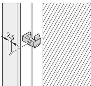
Clip de fijación para montaje de PCB al panel frontal con manija del extractor keyform 1.
