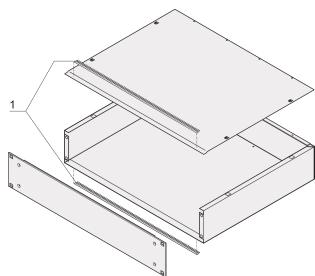
El kit de protección EMC y las placas de cubierta aumentan el blindaje del chasis de aproximadamente 30 dB(A) a aproximadamente 60 dB(A). Se puede descargar un informe de prueba.
