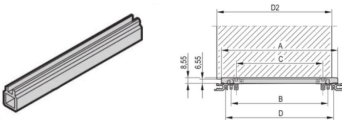
Carril guía de media pieza para carriles guía individuales de varias piezas de extrusión de plástico o aluminio. Adecuado para estándar, Accesorio, 4,4" tipos de PCB y piezas finales con codificación.
