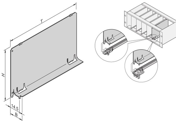
El deflector de aire sin un panel frontal parcial se puede combinar con un panel frontal que cubre todo el ancho. Cubre una ranura vacía para eliminar una fuga de aire.
