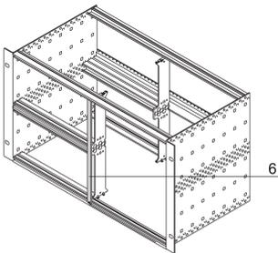
El panel frontal ancho de 2 HP cubre una ranura abierta. El panel frontal de perfil en U se puede combinar con una junta EMC textil. Se fija con tornillos y arandelas. Debido a la anchura de 2 HP no se pueden utilizar mangas.
