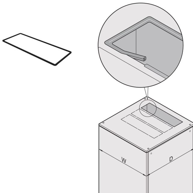
Cubrir los bordes afilados de los recortes. Proporciona protección contra lesiones y evita daños en los cables insertados. La protección Varistar Edge es adecuada para zonas de corte de cubiertas superiores.
