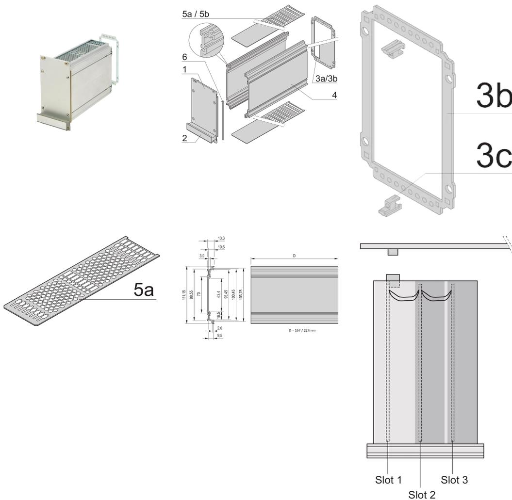
Protege un PCB contra daños mecánicos y descarga acumulación electrostática; para formatos Euroboard; par con panel con recortes para más conectores.
