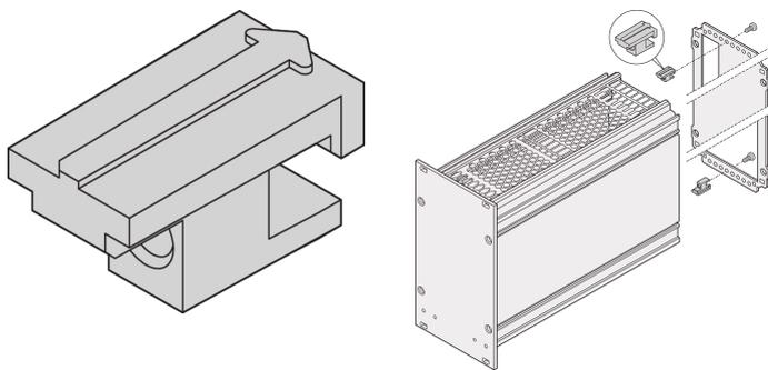
Sujetador de panel trasero para unidades enchufables tipo marco, kit con tornillos de fijación. Para aumentar la robustez de unidades plug-in de tipo marco más ancho.
