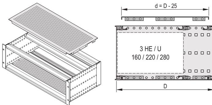
Una placa de cubierta se utiliza para blindaje electromagnético o como protección mecánica. La cubierta se puede atornillar en el panel lateral. Se puede utilizar para subpistas ferroviarias de acuerdo con SNCF.
