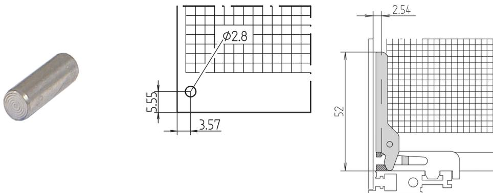
Para la inserción en el agujero de las placas de circuito. El pin conecta el mango con la placa de circuito.
