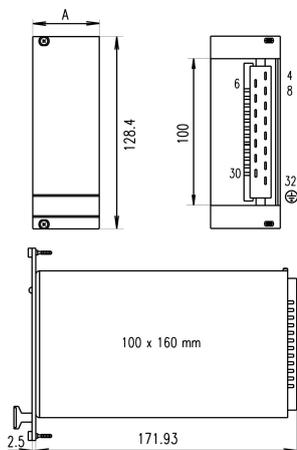
Panel frontal para nVent SCHROFF 19" fuente de alimentación compatible. Panel frontal plano con ranuras verticales para tiras de contacto EMC de acero inoxidable.
