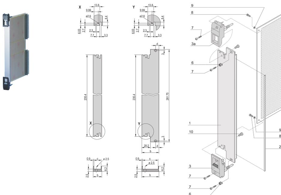
Unidad enchufable, con mango de insertor/extractor IET negro, 3 U, montaje frontal. El panel frontal en forma de U permite el blindaje con una junta textil.
