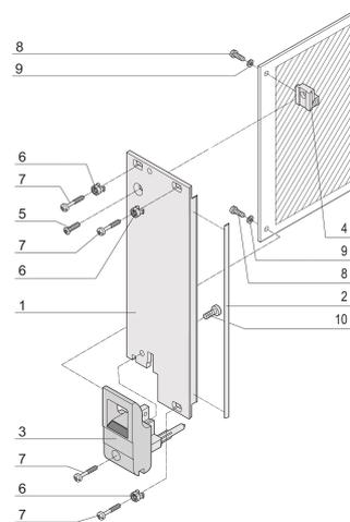
Unidad enchufable, con mango de insertor/extractor IET negro, 3 U, montaje frontal. El panel frontal en forma de U permite el blindaje con una junta textil.
