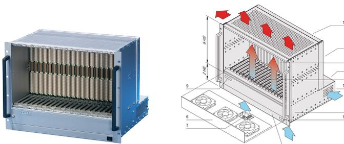
Sistema VME64 para 21 placas VME64x 6 U, 160 mm. Opción de E/S trasera La alimentación del sistema se suministra mediante una fuente de alimentación de marco abierto. Un módulo de control de ventilador monitorea los ventiladores, la temperatura y el voltaje.
