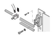
Abrazaderas de conexión disponibles en múltiples secciones transversales basadas en los requisitos del cliente.
