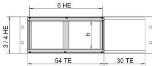
La jaula de tablero para tableros horizontales ofrece la opción de insertar 6 tableros U en una subpista de 3 o 4 U de alto o cajas de escritorio. Pease agregue un panel frontal para cubrir el Kit de montaje.
