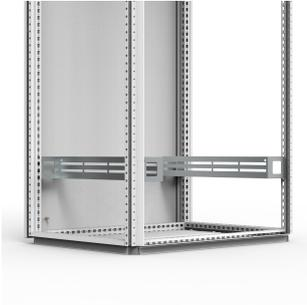
Estos perfiles se fijan al marco en armarios de 800 mm de ancho de altura completa o parcial para montar perfiles de 19". También se pueden utilizar para reforzar los perfiles de 19" de altura completa si se montan de manera transversal en el centro del armario.
