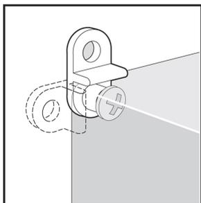
El kit de soportes de montaje tiene cuatro soportes de polycarbonato y cuatro tornillos chapados autorroscantes M4. El kit puede instalarse en campo. Úselo en todos los gabinetes QLine E. Mantiene las clasificaciones para el gabinete enumeradas.
