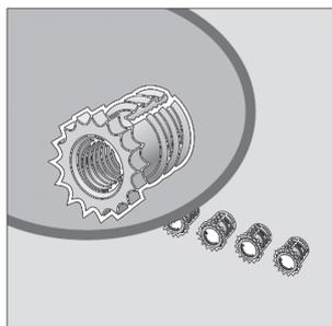
El inserto de latón QLine E es un inserto de latón autorroscante que se ajusta en las almohadillas moldeadas en la parte inferior del gabinete. Los insertos tienen una rosca interna M2 y una rosca externa autorroscante M4.
