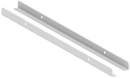
Las barras de elevación brindan la mejor distribución de la carga al elevar gabinetes unidos, cada uno de los cuales contiene hasta 3000 lb por bahía de equipo y cableado. Las barras se montan en la parte superior de los bloques de esquina del marco del gabinete y no requieren la extracción de la cubierta superior para la instalación. El kit consta de dos barras, tornillos y arandelas.
