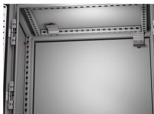
El kit de placa de conexión a tierra es eficaz para las cubiertas ProLine o ProLine G2 al marco. El kit consta de un soporte diseñado para la conexión a tierra de la cubierta trasera, un conjunto de soportes para la conexión a tierra de las cubiertas superior y lateral, y los herrajes para fijar los soportes al marco.
